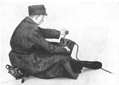
Fig. 11 Inbetriebsetzung des Handgenerators
